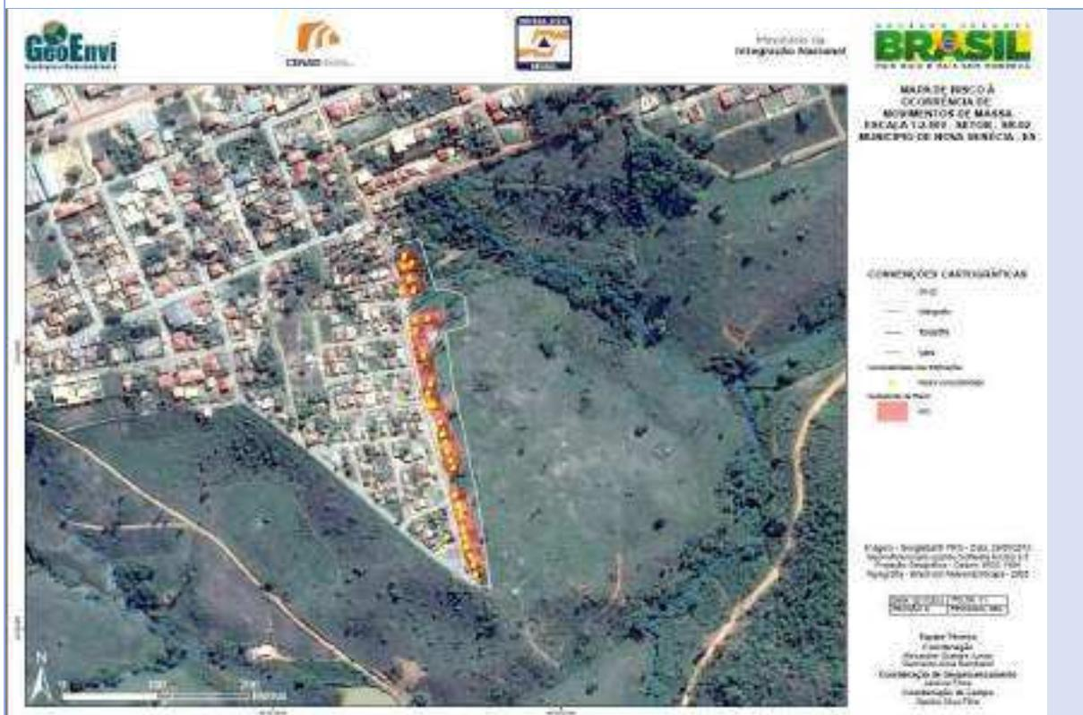
Descrição SR-02 – Bairro Alvorada: erosão superficial com perda de sustentação do talude e das moradias. Risco: movimentação de massa e enxurradas.
