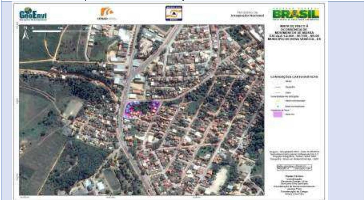
Descrição SR-06 – Yolanda: erosão superficial em solo arenoargiloso de declividade acentuada, falha na drenagem de águas pluviais. Risco: Movimentação de massas.
