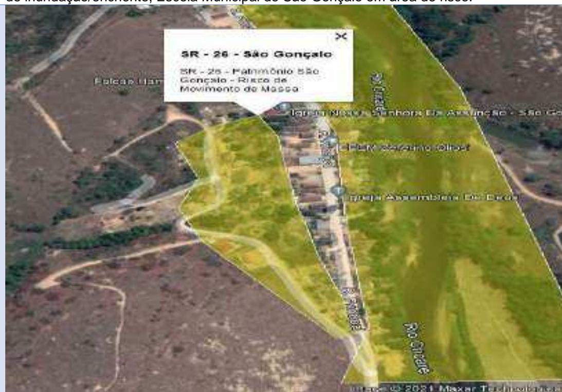
Descrição SR-26 - Patrimônio São Gonçalo – Zona Rural: talude natural foi realizado diversos talude de corte, sem estruturação para ocupação residencial, sem qualquer obra de drenagem pluvial ou escoamento superficial, sem obras de contenção, risco de movimento de massa.
